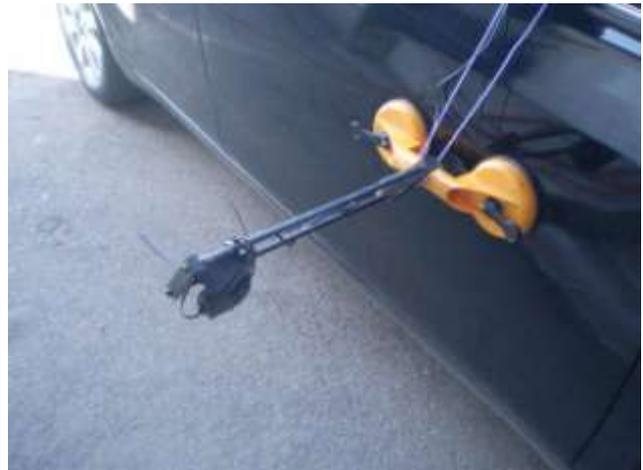
**figura 42 e 43: Instalação do recurso Caixa Preta Veicular na lateral direita do veículo, aderido através de suporte com ventosas de fixação**
