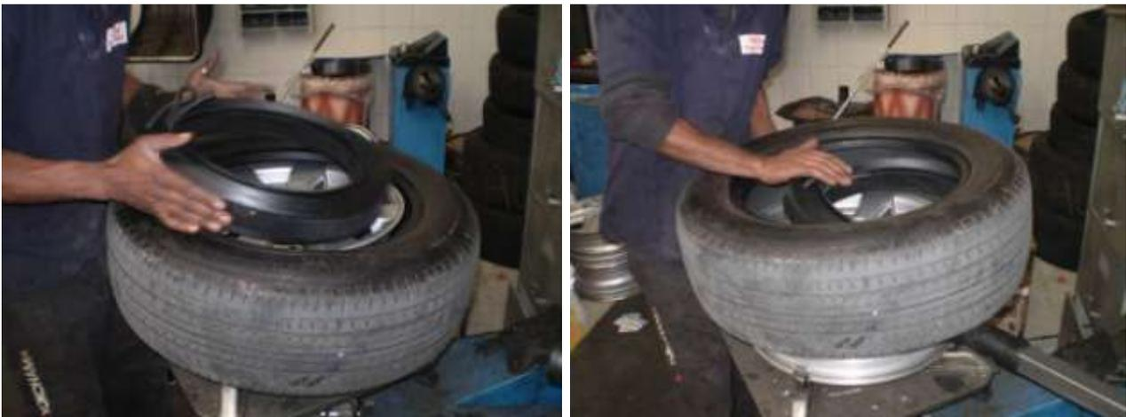
**Figuras 17 e 18: inserção do equipamento no interior do conjunto pneu/roda**
