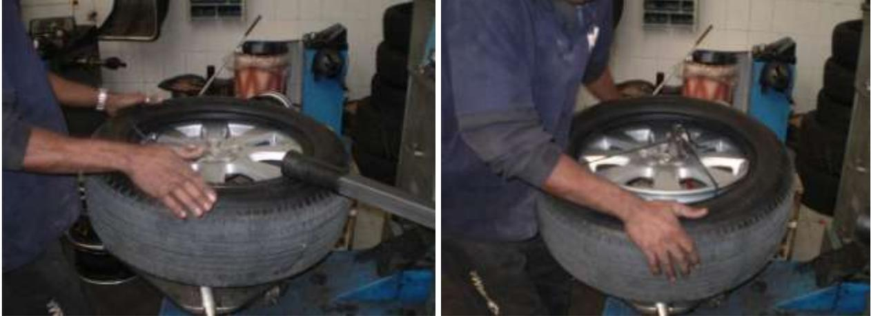
**Figuras 19 e 20: Ajuste da alocação do equipamento no interior do conjunto roda e utilização de recursos como tira de borracha e chave de inserção de peso em rodas**
